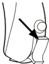
Ist das Hörsystem ausgeschaltet, ist die Aufschrift „OFF“ sichtbar.
