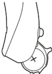
Bei Nichtgebrauch sollten Sie das Hörsystem an einem warmen, trockenen Ort aufbewahren und dabei das Batteriefach offen stehen lassen, damit das Gerät ausgelüftet wird und etwaige Feuchtigkeit verdunsten kann.
