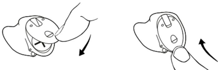
Um das Hörsystem auszuschalten, schieben Sie den Batteriefachdeckel nach unten.
