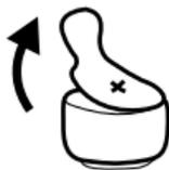
Entfernen Sie die Schutzfolie auf der Batterie, bevor Sie eine frische Batterie in das Hörsystem einlegen. Bitte warten Sie nach dem Entfernen der Schutzfolie einige Sekunden, bevor Sie die Batterie einlegen und das Hörsystem in Betrieb nehmen.
