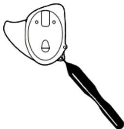
Entfernen Sie das Cerumen, indem Sie das lange Reinigungswerkzeug Nr. 3 durch die Belüftungsöffnung schieben.
