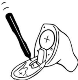
Führen Sie das kurze Reinigungswerkzeug Nr. 4 von innen durch die Mikrofonöffnung am Batteriefachdeckel (siehe Abb.).
