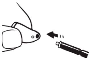
Setzen Sie den neuen Cerumenschutz am Schallauslass an und drücken Sie ihn vorsichtig hinein, so dass er sicher sitzt.
