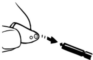
Ziehen Sie das Haltestäbchen heraus. Der neue Cerumenschutz löst sich dabei automatisch vom Haltestäbchen. Drücken Sie das Hörsystem mit leichtem Druck gegen eine flache Fläche, um sicherzustellen, dass der Cerumenschutz sicher sitzt.
