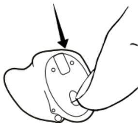
Schieben Sie den Batteriefachdeckel mit Hilfe des Nagelgriffs nach unten und öffnen Sie ihn. Der Deckel darf dabei nicht zu weit nach hinten geklappt werden.
