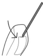
Benutzen Sie zum Öffnen des Batteriefachs das mitgelieferte Spezialwerkzeug wie gezeigt.
